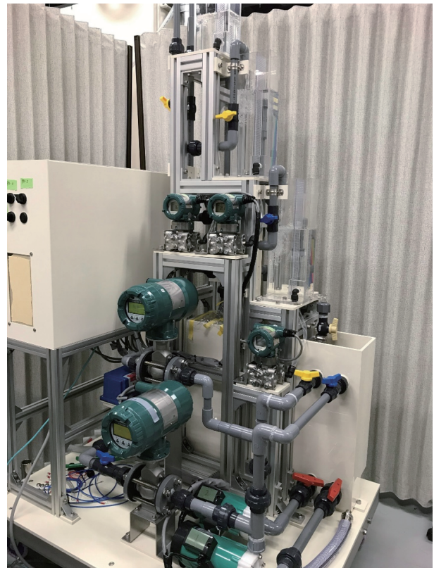
그림10 3단 물탱크 제어 시스템
